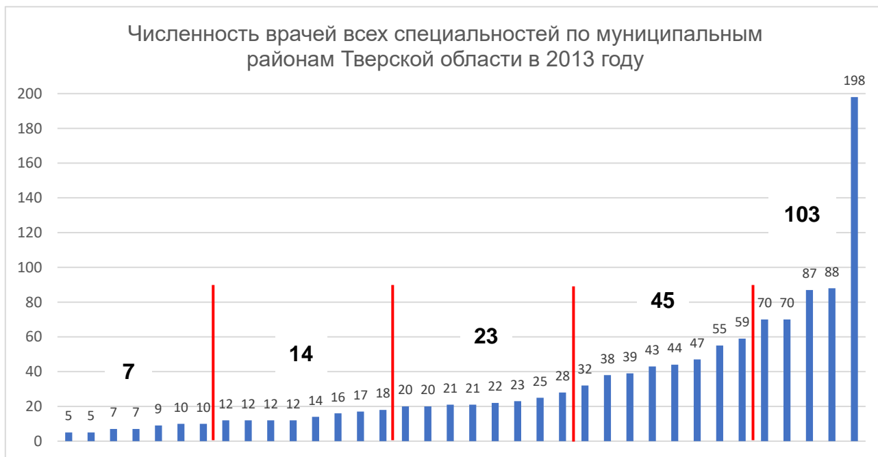
Рис. 5. Отфильтрованный график распределения картографируемого показателя с рассчитанными среднеарифметическими значениями для каждого класса
